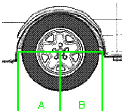
En posición estática el neumático no puede estar hundido en el paso de rueda con la excepción de que el modelo real tenga esa característica. (Ver apartado 5.2 del reglamento) El hundimiento nunca será de más de 1,5 mm y sólo en rallyes de asfalto, estando prohibido en los rallyes de sucio.
